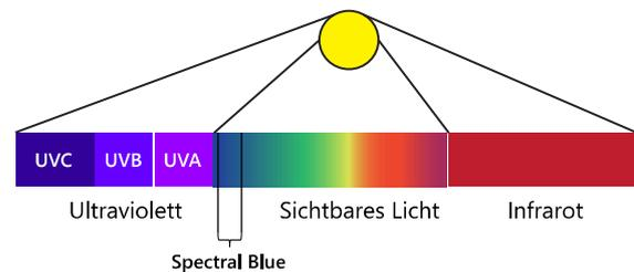
Spectral Blue-Geräte verwenden mehrere UV-freie sichtbare blaue Lichtwellenlängen zwischen 405 und 470 nm.
